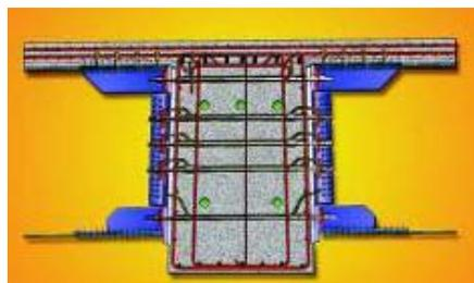
Figure 9 : Integral Pier Cap
